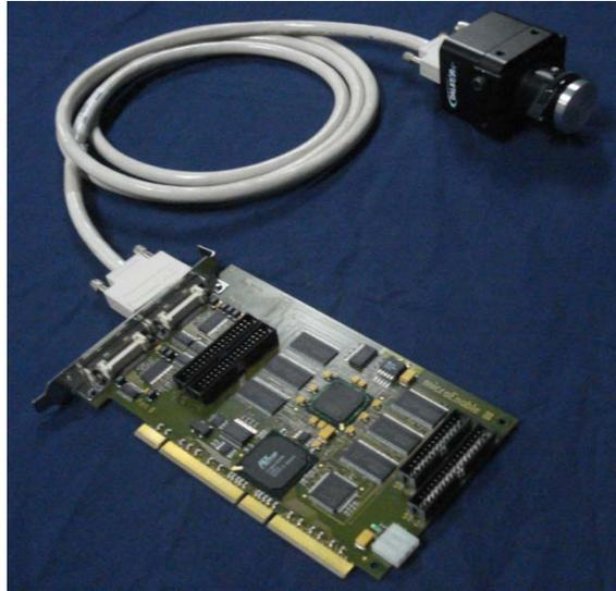
Fig. 2. Fast Shack Hartmann Wavefront Sensor
